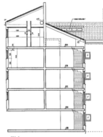
Figur 4.3. Sektion genom trapphus 2
